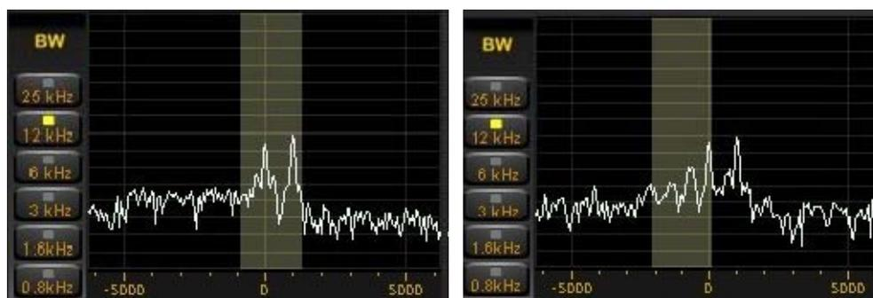
PBTの操作で近接局からのQRM(混信)を除去することができます。
