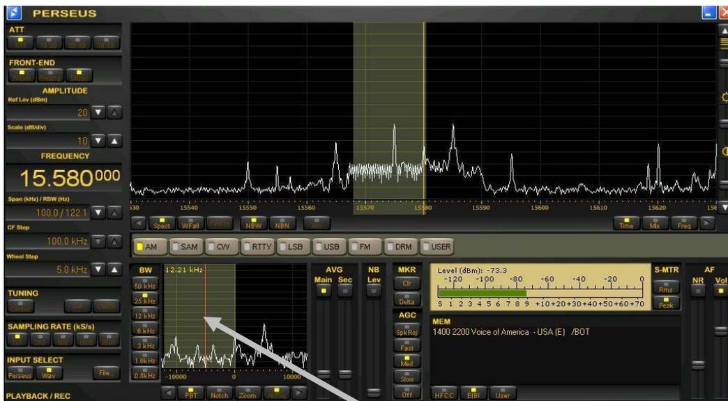
セカンダリ・バンド幅・ウィンドウにて、マウスの右ボタンを押しながらマウスを左右に動かし、フィルタの微調整をします。
