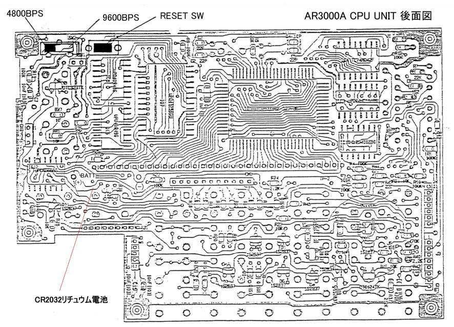
リチュウム電池の交換方法は市販されているボタン電池に5cm位の赤黒線を用意し 黒色線を(-)に半田付けし赤色線を(+)に半田付けして、古い電池は取り去り(+)パターン に赤線を半田付けし黒線を(-)パターンに半田付けし作業は終了です。
