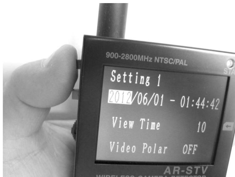
日時のいずれかの項目を変更して、軽くジョグダイヤルを押して値を決定した時点で日付または時刻が変更されます。
