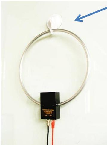
モバイル用のアンテナ基台を利用してループアンテナ部を固定する事も可能です。
