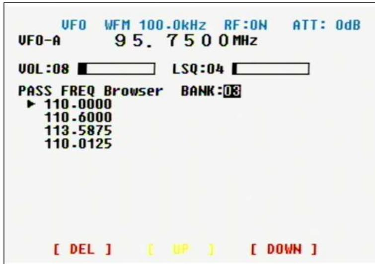
削除したい周波数にソフトキーの中央[ UP ]キー及び右[ DOWN ]キーを使ってカーソルを移動させます。ソフトキーの左[ DEL ]キーを押すと、カーソル指示のパス周波数が削除されます。
