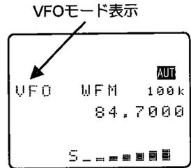
2VFOモードではVFO-AとVFO-Bの異なる2つの周波数を切り替えながら使用できますから、VFOモードよりも便利です。[2VFO]キーを押すとAとBの切り替えができます。お買い上げになって、はじめて電源を入れたときは2VFOモードになります。VFOモードでも2VFOモードでも周波数のあわせ方は同じです。2VFOモードでは上段に大きく表示されているほうが受信している周波数です。
