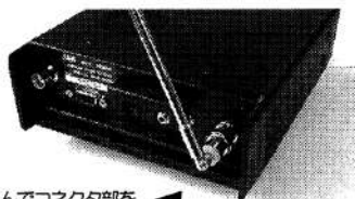
差し込んでコネクタ部を時計方向に約 1/4 回転
