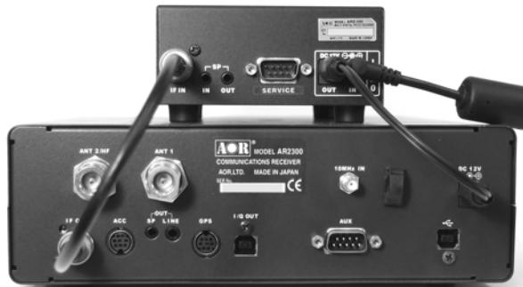
上の写真のように、付属の IF 信号ケーブルで、受信機の「IF OUT」端子と本装置の「IF IN」端子との間を接続します。
