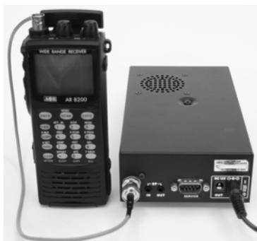
左の写真のように、IF 出力ケーブル(IF8200)の BNC コネクタを ARD300 の「IF IN」端子に接続します。
