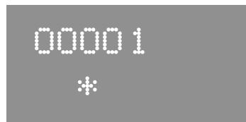
カーソルが「\*」文字の場合にその真上の桁を【▲】(上)キー、または、【▼】(下)キーを操作して、1 ずつ増減して変更できます。
