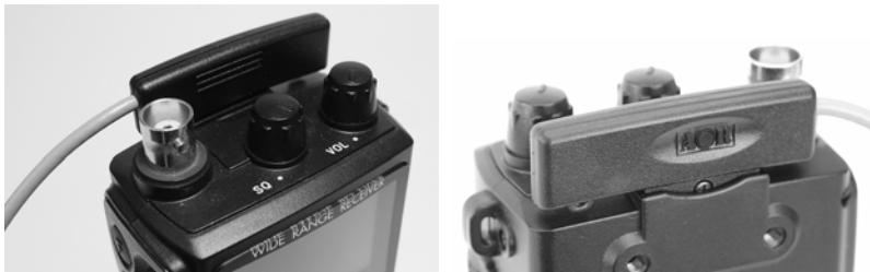
左の写真のように AR8200MK3 上部の「BC 帯用補助アンテナ」挿入口に IF 出力ケーブル(IF8200)を装着してください。
