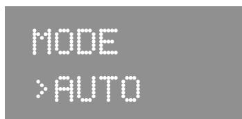
「MODE」表示の 2 行めが目的のデジタル通信方式に対応した表示になるように、[▲] (上)キー、または、「▼」(下)キーを操作し、目的の表示のときに [ENTER] キーを押してください。
