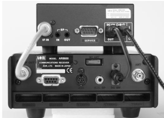
上の写真のように、付属の IF 信号ケーブルで、受信機の「IF OUT」端子と本装置の「IF IN」端子との間を接続します。
